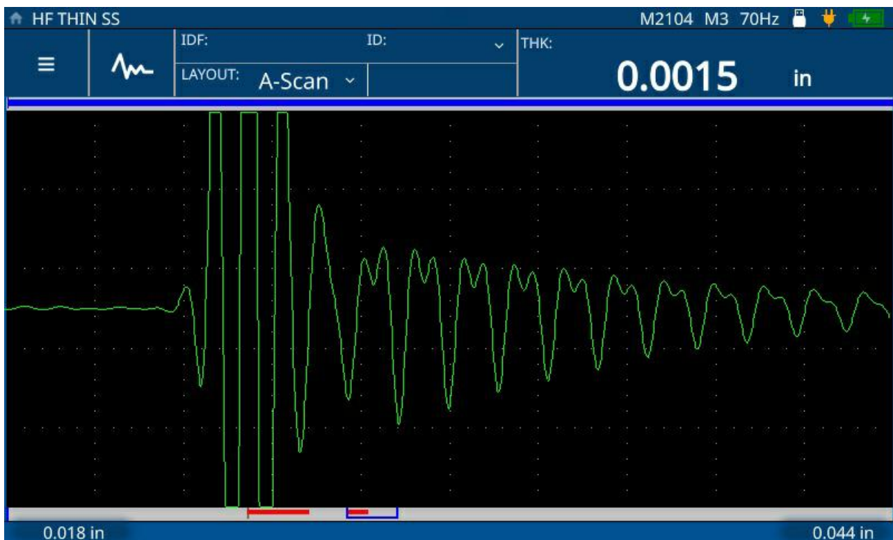
El medidor 72DL PLUS ejecuta una medición sobre acero delgado (0,0381 mm o 0,0015 pulg.) con la sonda M2104 (125 MHz).
